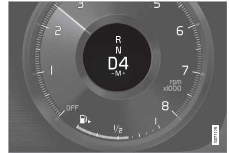
Дисплей водія під час зміни передач пелюстками під кермом.
