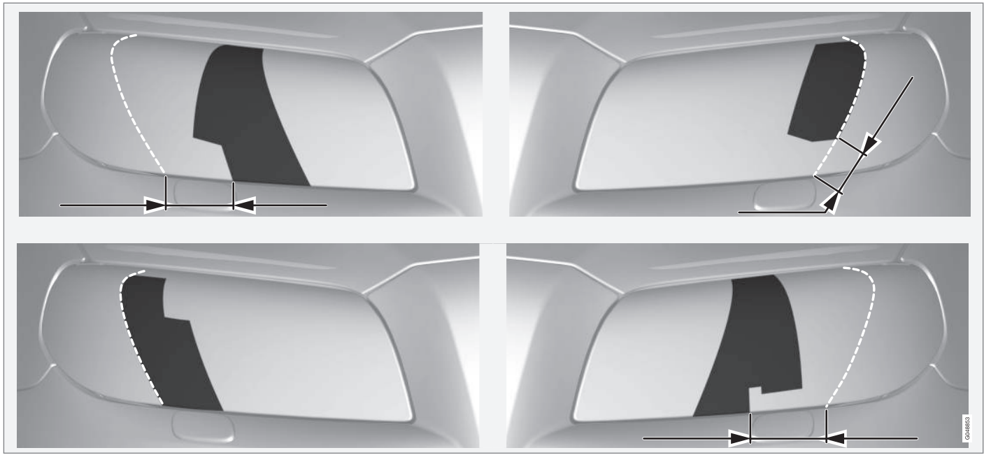
Ülemine rida: vasakpoolse rooliga autodele, šabloonid A ja B. Alumine rida: parempoolse rooliga autodele, šabloonid C ja D.
