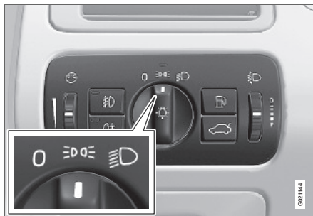
Valokatkaisin seisontavalojen asennossa
