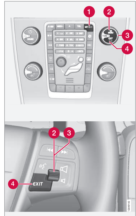
Keskikonsolin ohjauspaneeli ja ohjauspyörän painikesarja. Kuva on kaaviomainen - toimintojen ja painikkeiden sijainnit voivat vaihdella.
