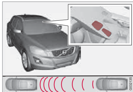
レーザーセンサーの送信/受信ウインド 17
