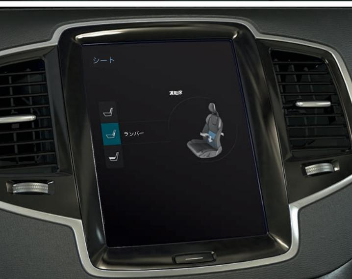
マッサージ\*、サイドサポート\*、ランバーサポート\*、シートクッションエクステンションの設定は、マルチファンクションコントロール\*とリンクしています。
