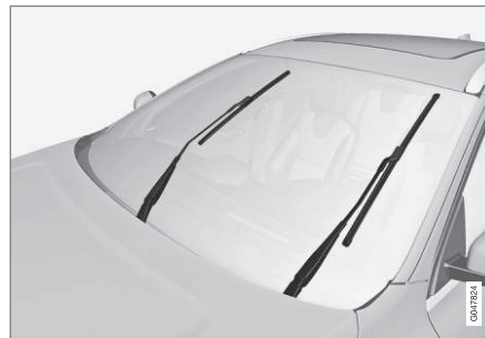
Spazzole tergicristallo in posizione di assistenza.
