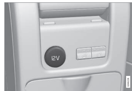
Preso da 12 V nel tunnel, sedile posteriore.
