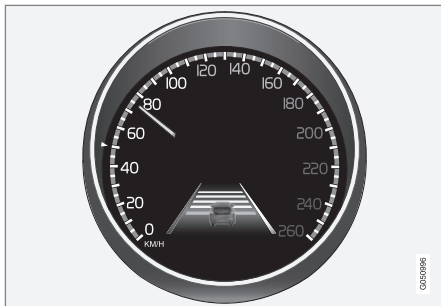
Linee laterali della funzione LDW.
