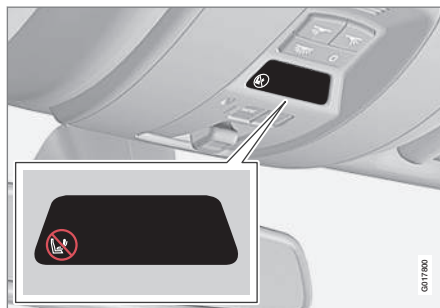
Indicazione dell'airbag lato passeggero attivato.
