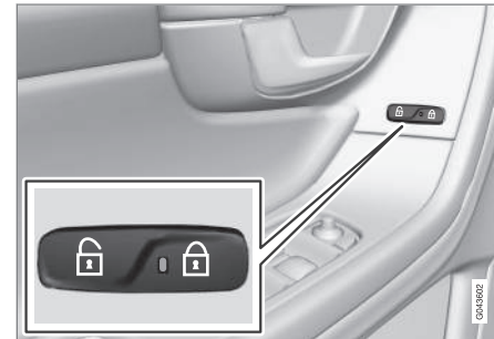
Pulsante della chiusura centralizzata
