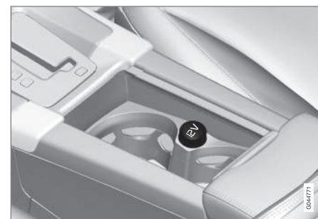
Preso da 12 V nel tunnel, sedile anteriore.
