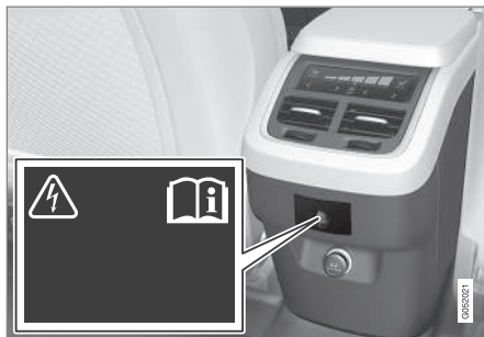
Presseletrica da 230 V nel tunnel, seconda fila di sedili.
