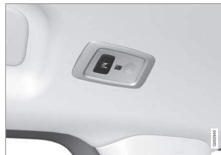
Luce di lettura sopra la seconda fila di sedili nelle automobili con tettuccio panoramico*.
