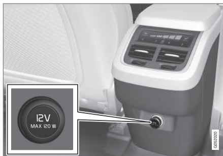
Presse elettriche da 12 V nel tunnel, seconda fila di sedili.
