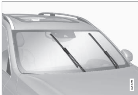
Spazzole tergicristallo in posizione di assistenza.
