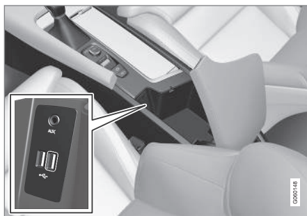
Presa USB nel tunnel.
