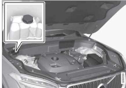
Serbatoio di espansione dell'impianto di raffreddamento.
