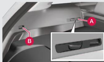
3. Placez l'un des verrous arrière en (B) et pressez le bouton de verrouillage en avant.
