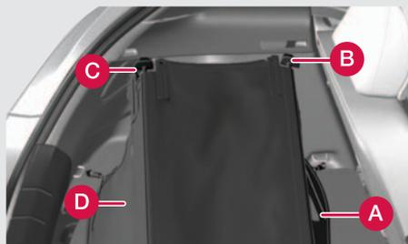
1. Accrochez les crochets au niveau du plancher (A).
