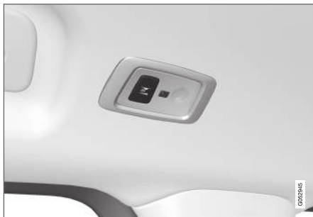
Een auto met panoramadak* is voorzien van twee lampjes: aan beide zijden van het plafond één. 10
