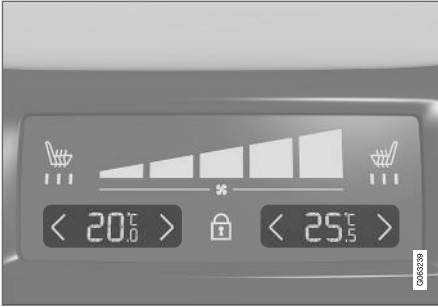
Temperatuurregeling op klimaatpaneel achter op tunnelconsole.
