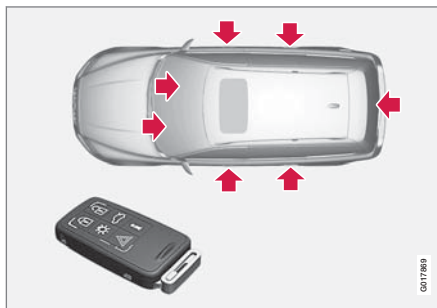
附帶鑰匙片的遙控器有效鎖定位點。
