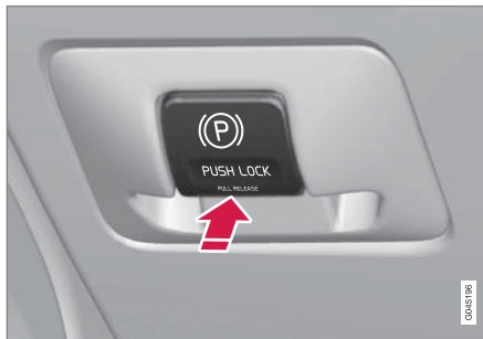
駐車煞車控制 - 使用。
