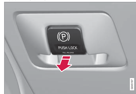
駐車煞車控制 - 釋放。
