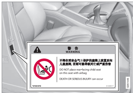
位置 2：乘客側門柱防護氣囊標籤位置。防護氣囊標籤可在開啟乘客車門時看到。
