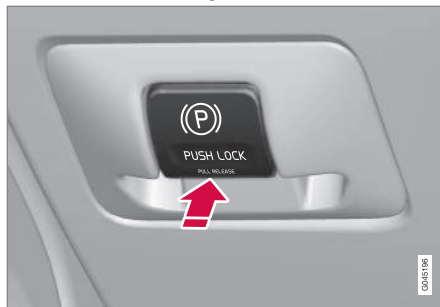
Stāvbremzes vadība - ieslēgšana.
