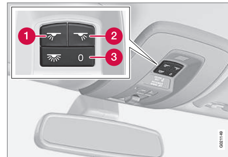
Priekšējo lasāmlampu un salona apgaismojuma slēdži jumta konsolē.
