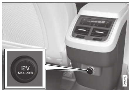
12V-aansluiting in tunnelconsole, tweede zitrij.
