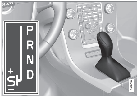
D: Automaattiset vaihdeasennot. +S- : Manuaaliset vaihdeasennot. S: Sport-tila*.
