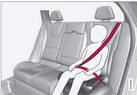
Oikea sijainti, vyön pitää olla asetettuna reilusti olkapään päälle.
