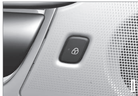
Knapp for låsing i bakdør med indikatorlampe.
