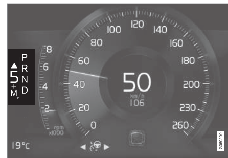
Girskiftindikator for stor girspak på 8-tommers førerdisplay.
