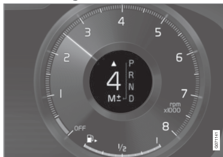
Girskiftindikator for stor girspak på 12-tommers førerdisplay*.
