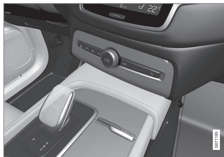
Oversikt over liten girspak der det ikke er mulig å deaktivere girspakspærren.
