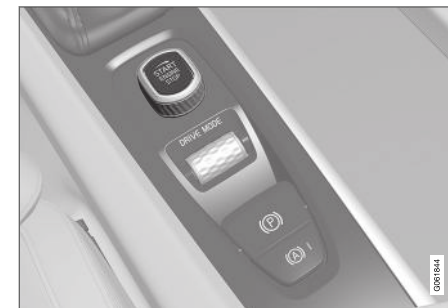
Startknappen i tunnelkonsollen.
