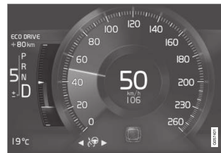
Eco műszer a 8-hüvelykes járművezetői kijelzőn.
