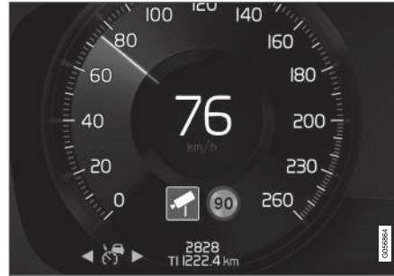
Sebességmérő kamera információk a járművezetői kijelzőn 105 .
