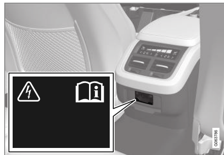
Elektromos aljzat az alagút-konzolon, hátsó ülés.
