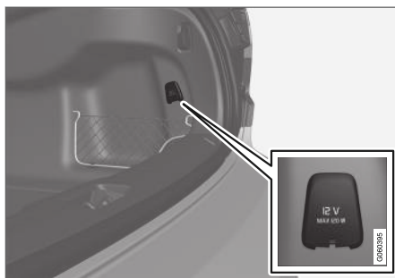
12 voltos elektromos aljzat a csomagtérben*.
