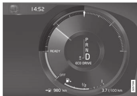
Eco műszer a 12-hüvelykes járművezetői kijelzőn*.
