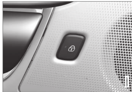
Záró gomb visszajelző lámpával a hátsó ajtóban.
