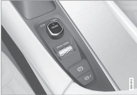
De startknop op de tunnelconsole.
