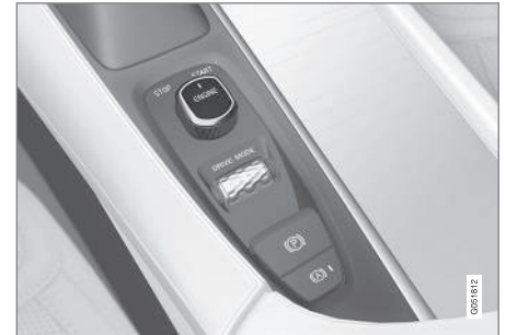
De startknop op de tunnelconsole.
