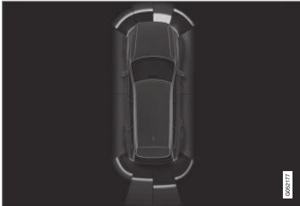
Bildeskjermvindu med hindringssoner og sensordetektorer.
