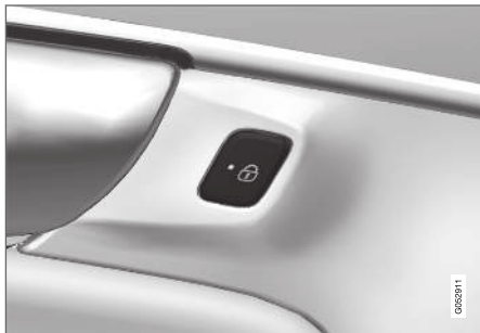
Låseknapp med indikatorlampe i bakdør.
