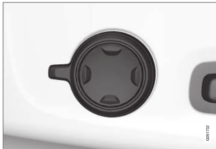
Multifunksjonsbryteren er plassert på siden av setteputen til setet.
