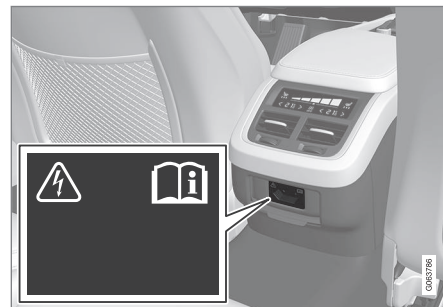
Presad alta tensione nel tunnel, sedile posteriore.
