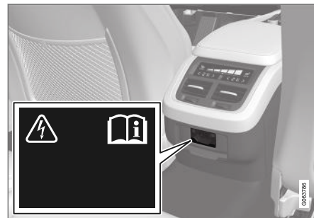
Stroomaansluiting in tunnelconsole, achterin.
