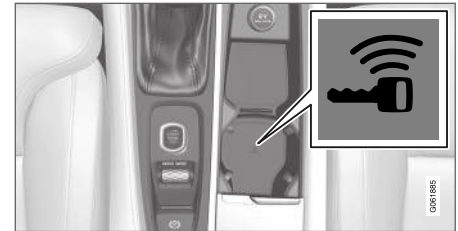
Positie back-uplezer in de tunnelconsole.
