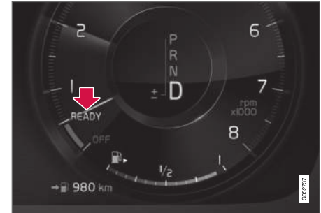
Het systeem is actief en de motor is automatisch afgezet.
