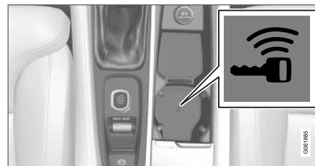
Positie back-uplezer in de tunnelconsole.
