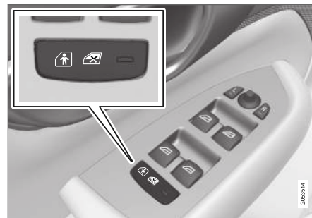
Knop voor elektrische activering en inactivering.
