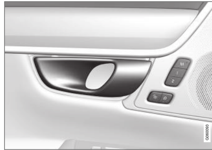
Openingsgreep voor alternatieve ontgrendeling op zijportier.
