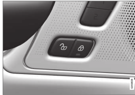
Zamykácí a odemykácí tlačítko s kontrolkou na předních dveřích.
