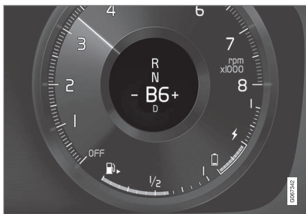
Vaihtamisosoitin kuljettajan näytössä 5 .
