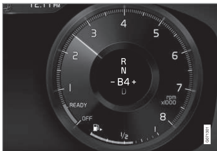
Kuljettajan näyttö vaihdettaessa ohjauspyörävalitsimilla käsinvaihtoasennossa.
