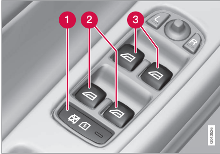
Sürücü kapısı kontrol paneli.
