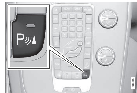
Til-/fra for sensorerne til Parkeringshjælp og CTA 28 .
