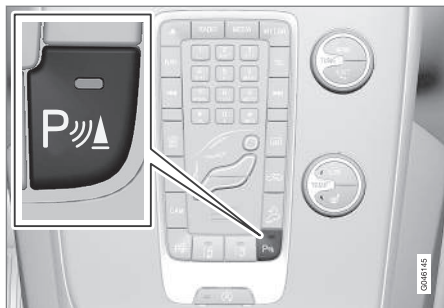
Til-/fra for sensorerne til Parkeringshjælp og CTA.
