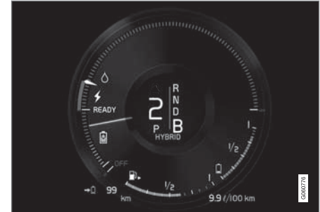
تشير شاشة السائق إلى عملية الشحن أثناء فرملة المحرك الكهربائي.
