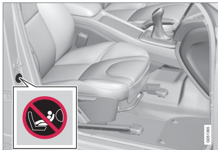
位置2：助手席側ドアピラーのエアバッグラベルの位置ラベルは助手席側ドアを開くと見えます
