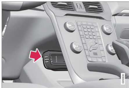
ハンドヘルドユニットの保管と充電ステーション
