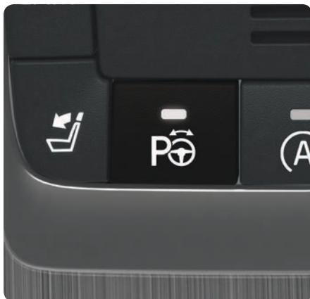
PAP (système d'aide au stationnement) détermine si l'espace d'un emplacement de stationnement est suffisant pour votre véhicule et aide à manœuvrer dans l'emplacement. Le conducteur sélectionne les rapports de boîte de vitesses, régule la vitesse du véhicule et applique les freins.
