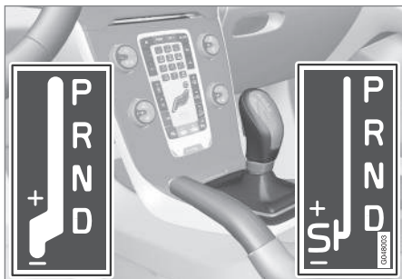
D: automatisch schakelen. +/-: handmatig schakelen. S: Sport-stand*. 7
