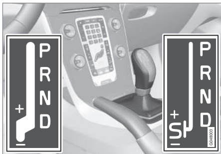
D: automatisch schakelen. +/-: handmatig schakelen. S: Sport-stand 5 .
