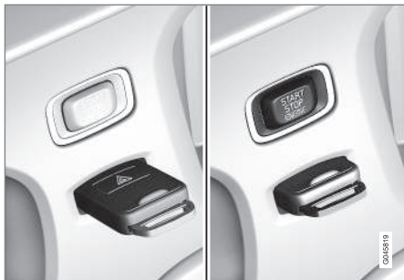
Contactslot met transpondersleutel uitgetrokken/ingeduwd.
