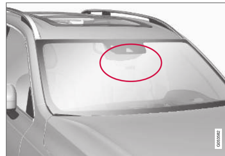
Emplacement du capteur radar.
