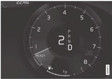
Écran du conducteur lors d'un changement de rapport à l'aide des palettes au volant
