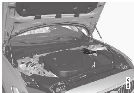
Вспомогательный аккумулятор установлен в моторном отсеке.
