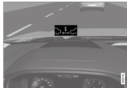
Символ контроля сближения на ветровом стекле автомобиля с проекционным дисплеем.
