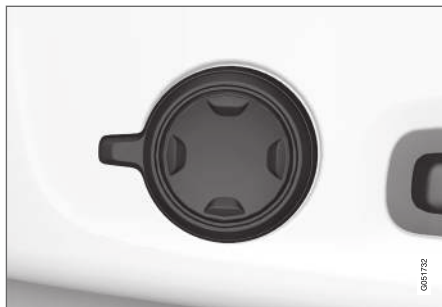
Джойстик в автомобилях с регулировкой опоры поясницы в четырех направлениях*.
