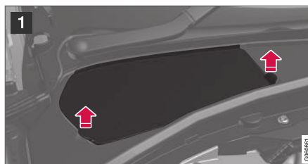
Expansionskärl för kylsystem, högerstyrd bil.
