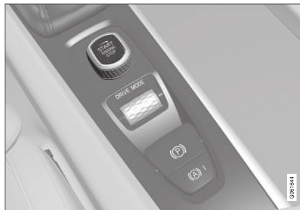
Startvredet i tunnelkonsolen.
