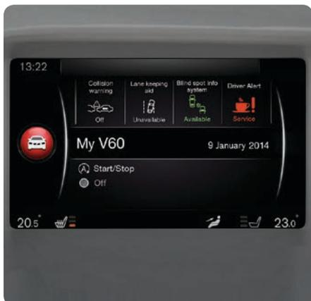
В **MY CAR** вы можете управлять многими функциями автомобиля, например, установкой времени на часах, настройкой внешних зеркал и замков.
