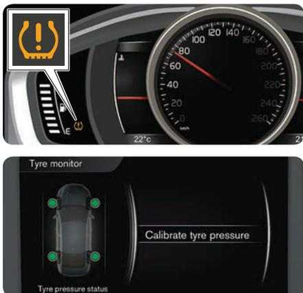
Калибровку необходимо проводить после каждой замены шин или изменения давления в шинах. Если загорается лампа (⚠), необходимо проверить давление в шинах и выполнить калибровку системы. Порядок выполнения работ:
