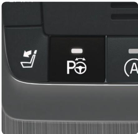
Система PAP проверяет наличие свободного пространства и затем направляет автомобиль в выбранное место. Ваша задача – внимательно следить за ситуацией вокруг автомобиля, выбирать передачи, регулировать скорость и тормозить/останавливать автомобиль.
