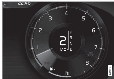
Panoramica dello schema di cambio sul display del conducente per la leva selettoria grande.
