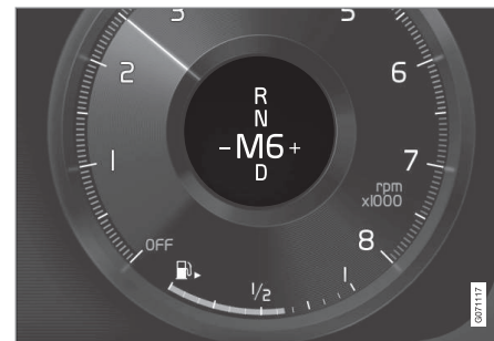
Panoramica dello schema di cambio sul display del conducente per la leva selettoria piccola.
