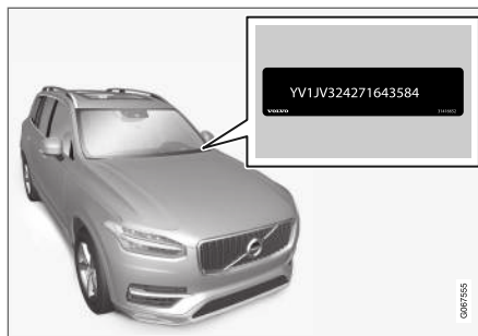
O VIN tem localização semelhante em todos os modelos.
