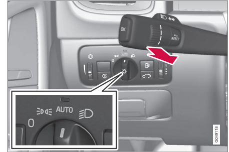
Rattspak och ljusreglagetets vred i läge AUTO .
