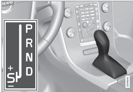
D: Automatiska växellådan. +S- : Manuella växellådan. S: Sportläge*.
