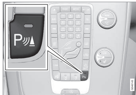
På-/Av för sensorerna till Parkeringshjälp och CTA.
