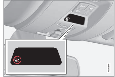
Indikering som visar att passagerarplatsens krockkudde är aktiverad.
