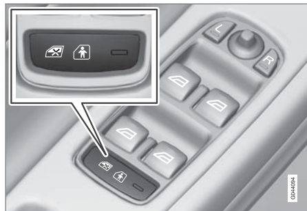
運転席ドアのコントロールパネル
