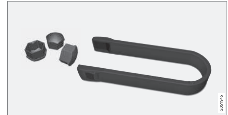
Instrumenti riteņu skrūvju plastmasas uzgaļu noņemšanai
