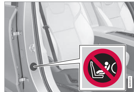
Uzlīme uz blakussēdētāja puses durvju statņa. Drošības gaisa spilvena uzlīme kļūst redzama, atverot pasažiera durvis.
