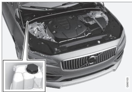
Ekspansionsbeholder for kølesystemet, venstre styret bil.
