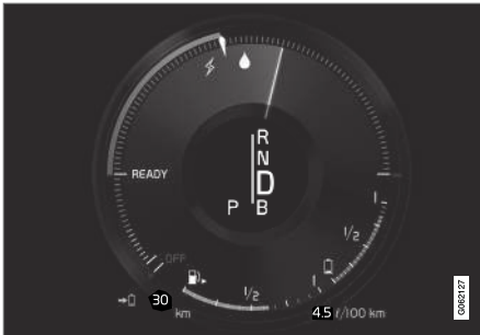
Juhiekraani teave elektri- ja sisepõlemismootori kasutamiseks.
