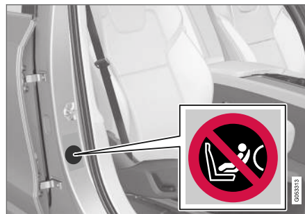
Juhi kõrvalistuja uksepiilaril olev silt. Turvapadja silt on nähtav juhi kõrvalistuja ukse avamisel.
