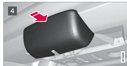
4 Задвинув, зафиксируйте защитную крышку.
