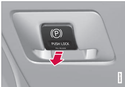
Seisontajarrun säädin - vapautettu.
