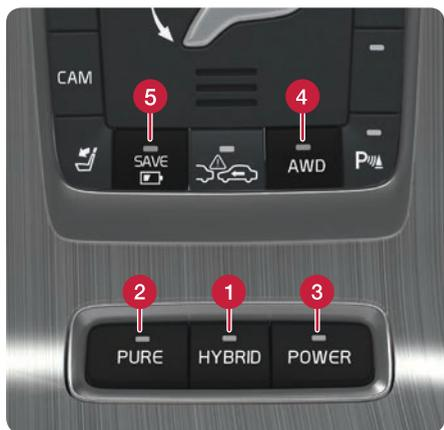
El vehículo se propulsa con dos motores: uno eléctrico y otro diésel. Pueden seleccionarse distintos modos de conducción. No se puede seleccionar un modo de conducción "equivocado". El automóvil regresará a modo HYBRID si no se cumplen ciertas condiciones. La lámpara del botón HYBRID se encenderá.
