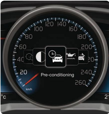
El preacondicionamiento se utiliza principalmente para optimizar el sistema de transmisión eléctrica del automóvil antes de utilizarlo. La función calienta o refrigera también el habitáculo y se activa directamente en el cuadro de instrumentos, con el mando a distancia\* o con la aplicación para móvil de Volvo On Call\*.
