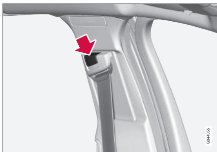
Høydejustering av sikkerhetsbelte. Trykk inn knappen, og flytt beltet i høyderetning. Plasser beltet så høyt som mulig uten at det gnisser mot halsen.
