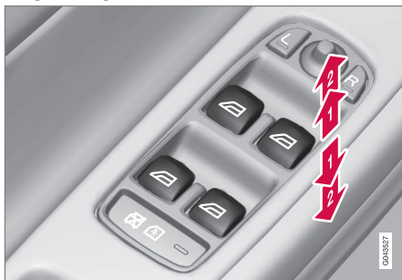
Regulering av vindusheiser.
