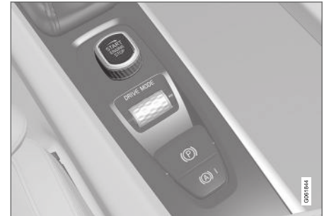
Botão de partida no console de túnel.
