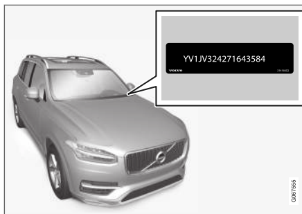
O VIN está posicionado em local parecido em todos os modelos.
