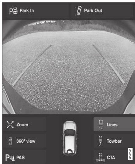
Exemplo de linhas do Assistente de Estacionamento.
