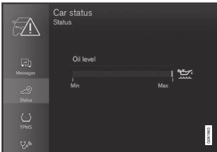
Gráfico do nível do óleo no visor central.
