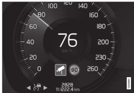
Informação de radar no visor do motorista.
