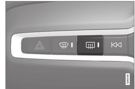
Botão físico no console central.
