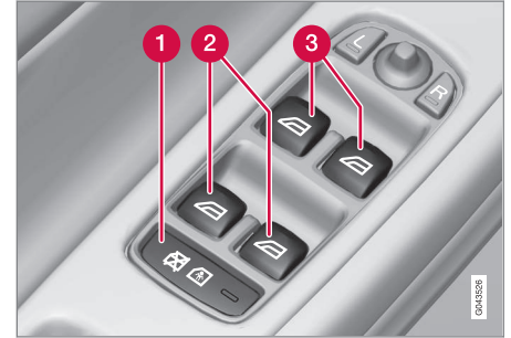
Säädinpaneeli kuljettajan ovessa.
