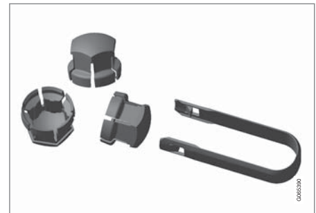
เครื่องมือสำหรับการถอดฝาปิดพลาสติกบนโบลท์ล้อ
