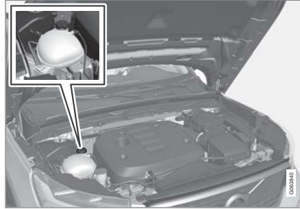
ถังพักน้ำหล่อเย็น
