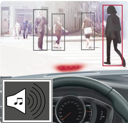
Automašīna ir aprīkota ar sadursmes brīdinājuma sistēmu ar automātisko bremzēšanu un velosipēdistu un gājēju aizsardzību, kas var brīdināt, bremzēt un/vai apturēt automašīnu, ja priekšā atrodas transportlīdzeklis, velosipēdistis vai gājējs.
