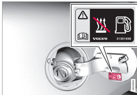
Varningsdekal på tankluckan.
